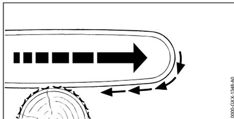
Quando se trabalha com a parte inferior do sabre, a motosserra é puxada para o lado oposto do operador.
