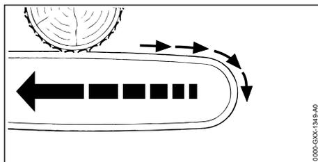
Quando se trabalha com a parte superior do sabre, a motosserra é repulsada na direção do operador.
