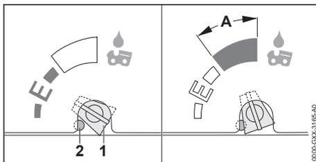
Se o parafuso de regulagem da bomba de óleo (1) estiver na posição E (Ematic), a vazão de óleo está ajustada idealmente para a maioria das aplicações.
